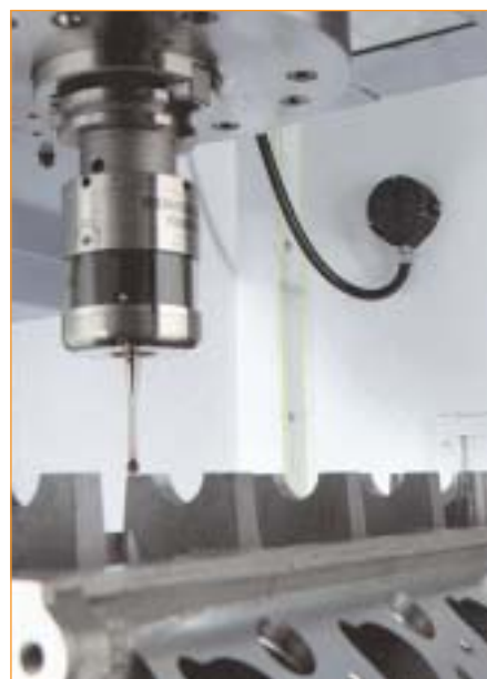
La sonda RMP60 durante l'ispezione di un componente. Sullo sfondo è visibile l'unità ricevitore/interfaccia RMI
